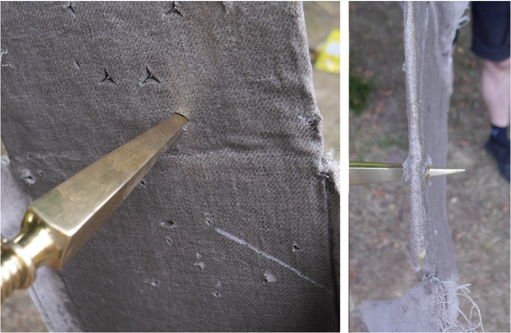
Abb. 11: Der Sauroter penetrierte die Platte deutlich tiefer als die Spitze. Manche historischen Funde zeigen entsprechende quadratische Löcher und machen damit deutlich, dass der Lanzenschuh keinesfalls nur als Gegengewicht und Schutz des unteren Schaftendes diente, sondern auch als Angriffswaffe genutzt werden konnte. – The sauroter penetrated the armour plate significantly deeper than the spearhead. Some historical finds have corresponding square holes which show that the spear butt was not only used as a counterweight and protection of the bottom end of the lance shaft, but as an assault weapon as well.
