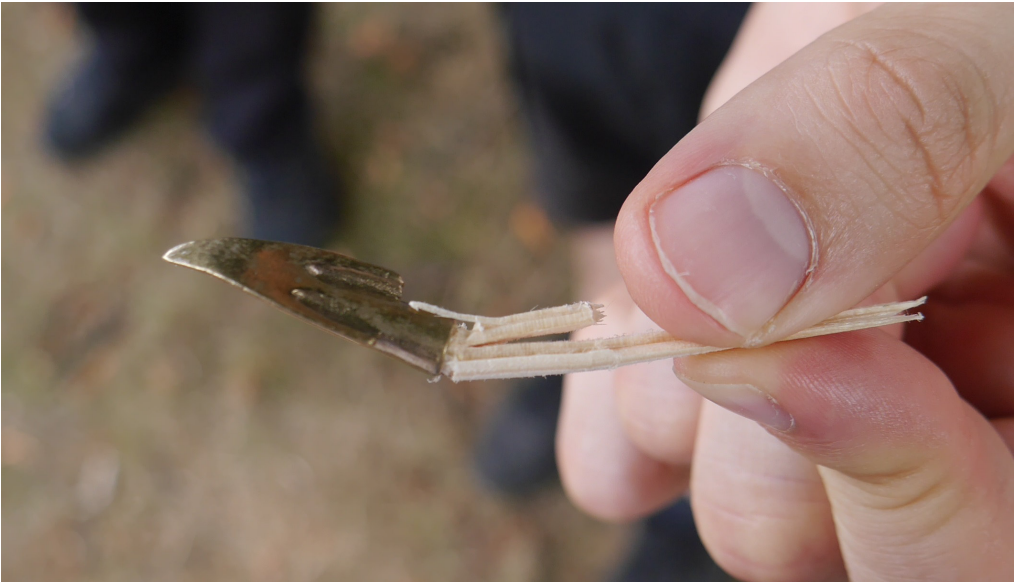
Abb. 8: Alle Pfeile, die wir auf die Teststücke schossen, brachen knapp unterhalb der Tülle ab. Da der Schaft mit Leim befestigt worden war, konnten wir die Holzreste nicht entfernen und die Spitzen nicht wiederverwenden. Bei frontalem Beschuss verbogen sich die Pfeilspitzen. – All arrows we fired at the armour plates broke shortly beneath the socket. Because the shaft was glued to the arrowhead, we couldn't remove the remains of the wood and use the arrowheads again. Direct shots onto the armour plates resulted in bent arrowheads.
