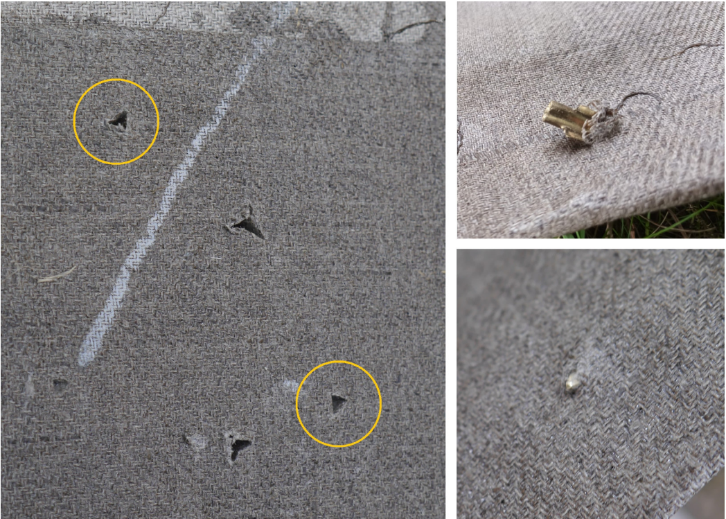
Abb. 9: Direkte Treffer mit Pfeilen hinterließen sichtbare Löcher (gelbe Kreise). Ein Pfeil, der schräg auf das Teststück geschossen wurde, hinterließ eine Spur, richtete allerdings keinen weiteren Schaden an. In einem Bereich der Platte, der nur sieben statt zwölf Lagen dick war, konnte eine Pfeilspitze das Material tiefer penetrieren, aber nicht durchdringen (rechte Seite). – Direct hits with arrows left visible holes (yellow circles). One arrow, which was shot at an angle, left a scratch but could not damage the material in any significant way. In the zone of the plate that was only seven layers thick instead of twelve, an arrowhead was able to penetrate but did not completely pierce through the linen.
